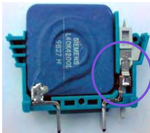
La soldadura se funde
