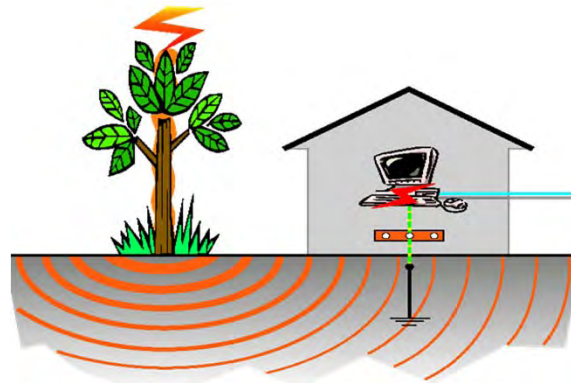
Aumento de potencial de tierra por descargas directas en elementos físicamente cercanos
